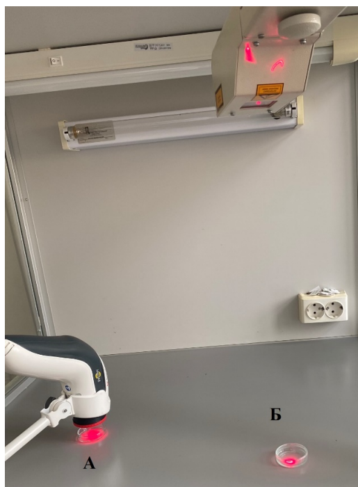
Рис. 1. Опромінення інокулюму мікроорганізмів PILER випромінюванням (А) та низькоінтенсивним лазерним випромінюванням (Б)
