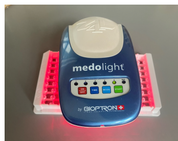
Рис. 1. Опромінення мікробного інокулюму світлодіодним випромінюванням
